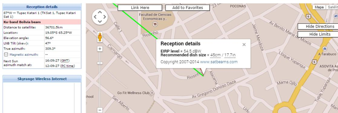
LA LÍNEA VERDE TE MUESTRA HACIA DONDE DEBES APUNTAR TU ANTENA EN EL PLANO HORIZONTAL (ÁNGULO DE AZIMUT).
