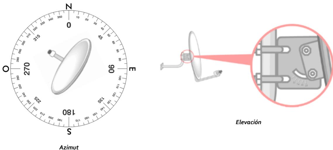
EL ÁNGULO DE AZIMUT SE MIDE A PARTIR DEL NORTE EN DIRECCIÓN DE LAS AGUJAS DEL RELOJ Y EL ÁNGULO DE ELEVACIÓN SE MIDE A PARTIR DE LA HORIZONTAL.
